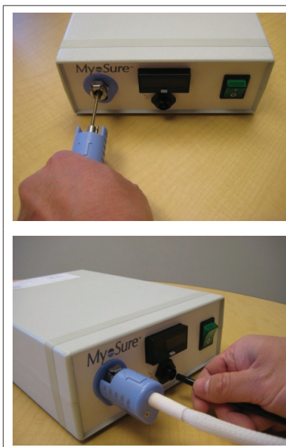
AFBEELDING 3. SLUIT DE AANDRIJFKABEL EN HET VOETPEDAAL AAN OP DE REGELEENHEID
