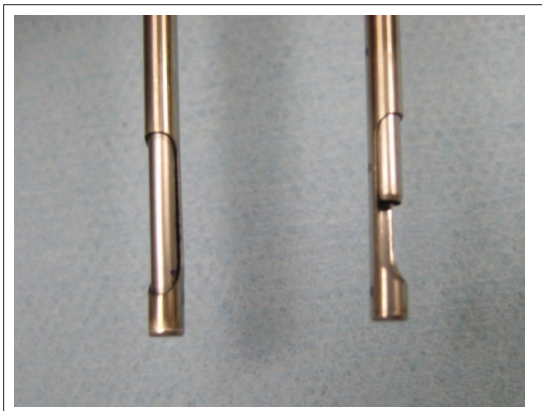
AFBEELDING 5. GESLOTEN SNIJVENSTER VAN HET WEEFSELVERWIJDERINGSINSTRUMENT LINKS
